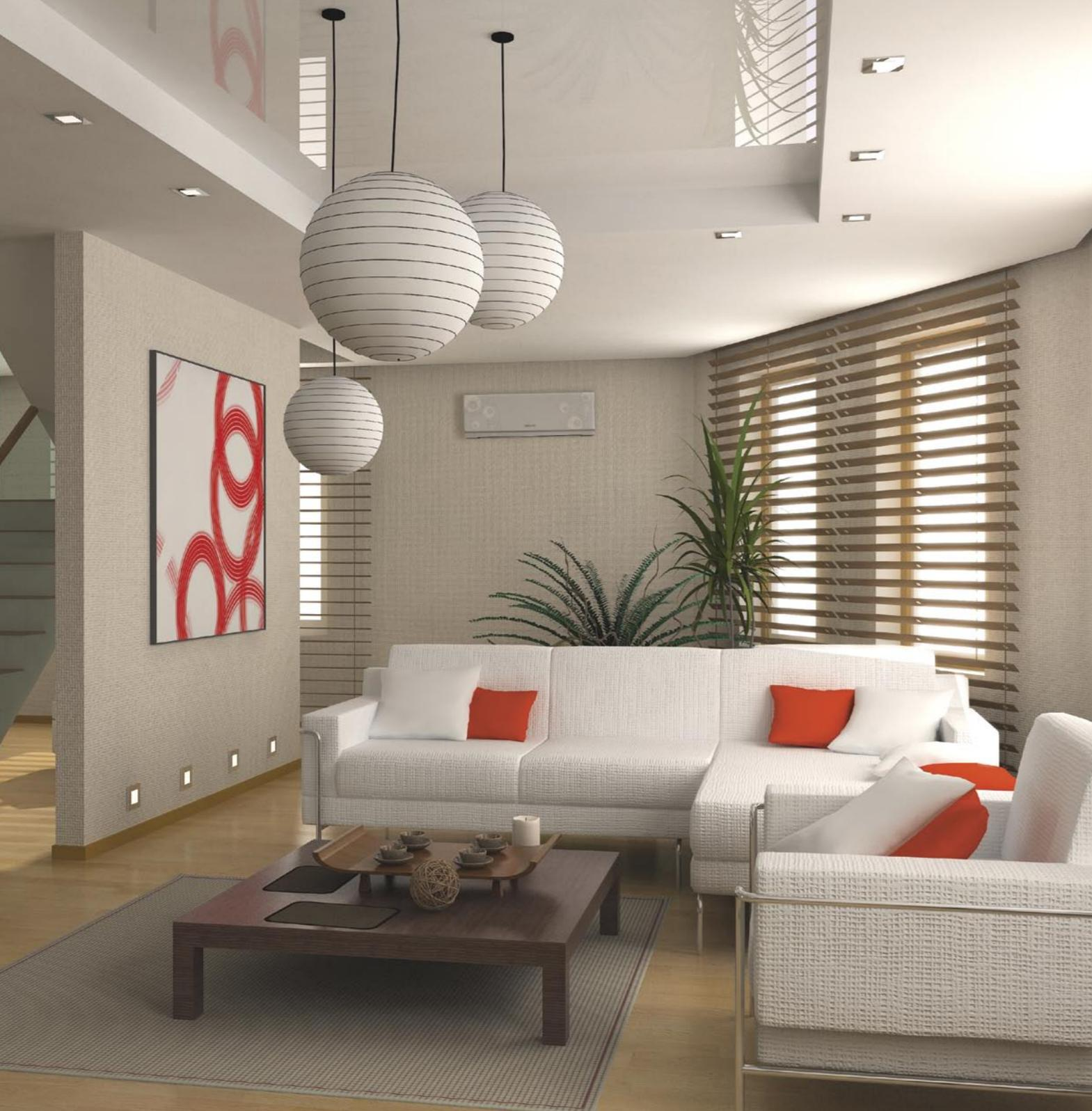
Бытовые кондиционеры применяют для создания комфортного микроклимата в помещениях небольшой площади. Наиболее часто используются сплит-системы настенного типа. Они удобны, компактны и хорошо вписываются в интерьер. Среди достоинств таких систем — холодопроизводительности как раз хватает для кондиционирования комнаты до 100 м<sup>2</sup>, низкий уровень шума, простота эксплуатации, дополнительные возможности очистки воздуха и широкие возможности программирования различных режимов.
