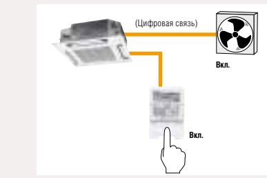
Вентилятор приобретается отдельно. Необходима дополнительная печатная плата (соединительный адаптер для внешних сигналов CZ-TA31P\*).
